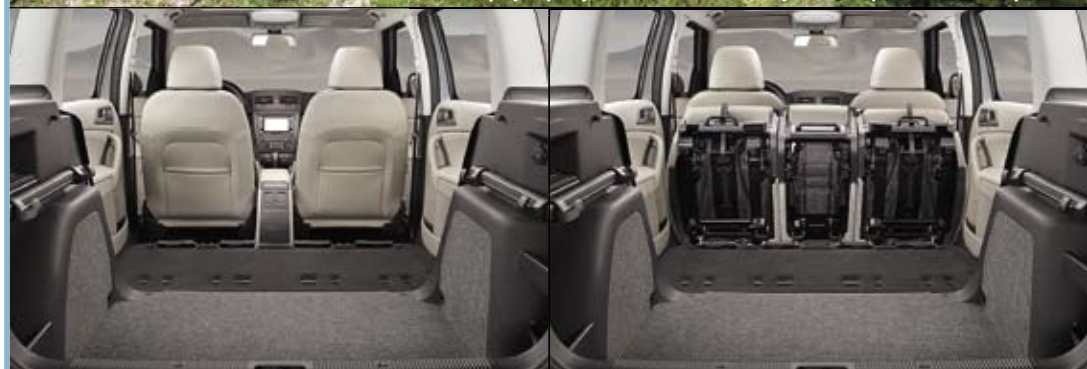
...тогда два оставшихся кресла сдвигаем к середине, и оба пассажира почувствуют себя намного вольготнее. Такая же система используется на Roomster.
