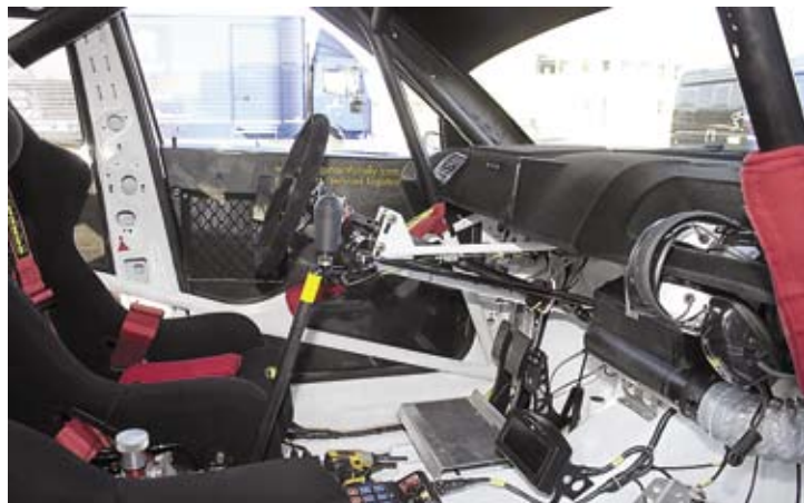
Внимание обычного водителя, несомненно, привлечет непривычное расположение рулевой колонки и ручки КП, но спортсменам такое решение кажется удобным и логичным.
