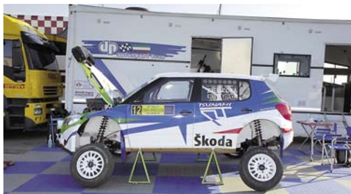
Расположенные под углом стойки – характерная особенность подвески Škoda Fabia S2000. Сами спортсмены, не сговариваясь, называют эту конструкцию «гениальной».
